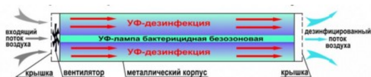
Принцип работы очистителя
